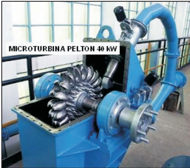
Figura-3.1. Turbina Pelton de um jato. Fonte: UCM (2004).
