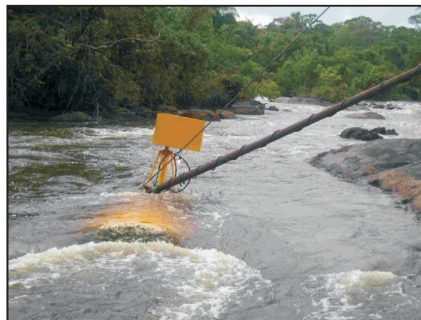
Figura-4.8. Testes operacionais da turbina hidrocínética no Rio Maracá. Fonte: ibidem .
