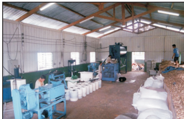
Figura-3.31. Galpão industrial do Roque e as prensas de 100 kg/h e de 400 kg/h.
