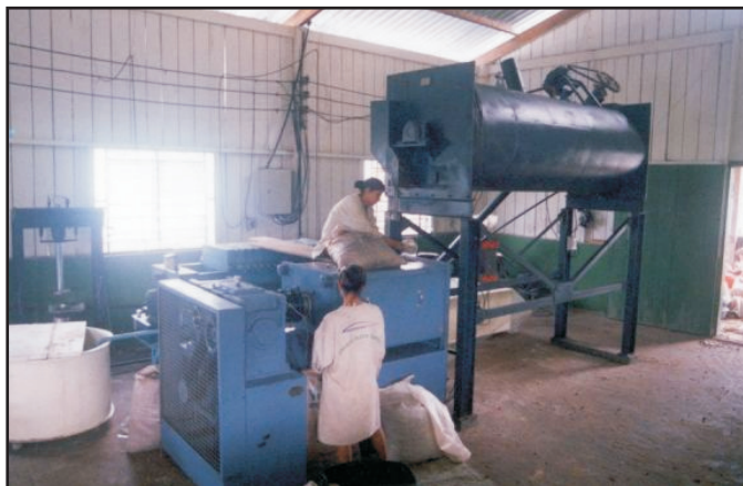
Figura-3.35. Prensa de 400 kg/h e o aquecedor da massa para melhorar a eficiência do processo.
