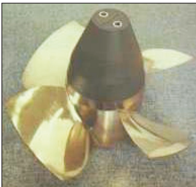
Figura-3.5. Turbina hélice. Fonte: UCM (2004).
