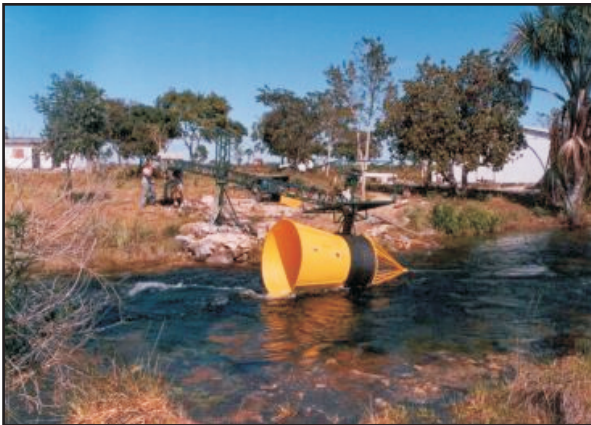
Figura-3.8. Turbina hidrocínética de eixo horizontal, de 1,8 kW, da UnB. Fonte: Van Els (2004).
