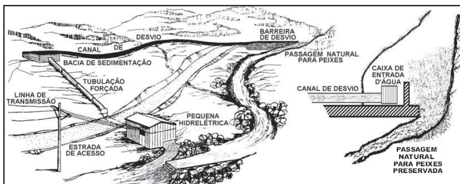
Figura-3.11. Pequena usina hidroelétrica com desvio parcial do rio. Fonte: Adaptado a partir de esquema do Banco Mundial (1991).
