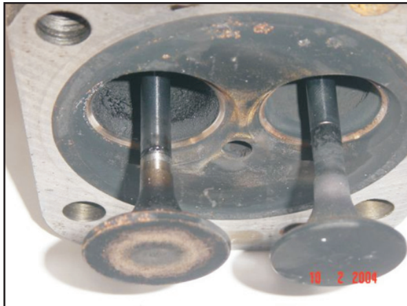
Figura-3.44. Aspectos da parte interna do motor Kiloskar após 100 h de operação.
