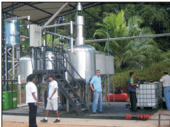
Figura-4.14. Usina de biodiesel por batelada em operação no rio Urubu.
