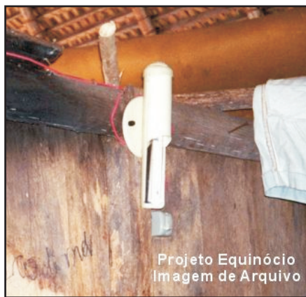
Figura-3.24. Luminária comercial de 12W, com alta taxa de falha. Fonte: Melo (2005).
