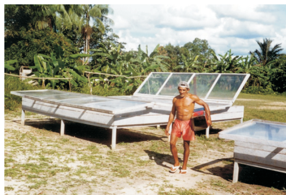
Figura-3.29. Secadores solares construídos pelo “Projeto de Óleos Vegetais”. Fonte: Correia (2004).
